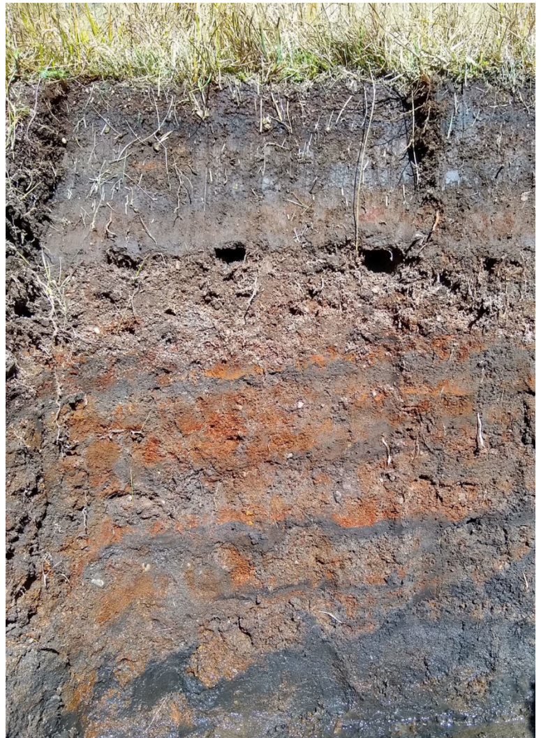
Figura 2. Perfil de un suelo ribereño del Iztaccíhuatl. El horizonte superficial oscuro indica acumulación de carbono orgánico. En el segundo horizonte se distingue una capa de materiales orgánicos enterrados, producto de antiguos aportes vegetales y procesos de sedimentación. Las tonalidades rojizas más profundas evidencian procesos de oxidación asociados a la dinámica del agua y a la fluctuación del nivel freático.
