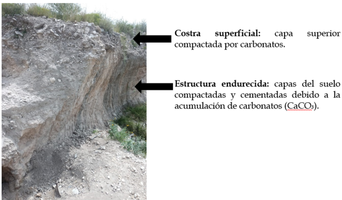
Figura 1. Perfil de suelo calcáreo donde se observa una costra superficial en la capa superior y una estructura endurecida en los estratos expuestos del perfil, ambas formadas por la acumulación de carbonatos de calcio.
